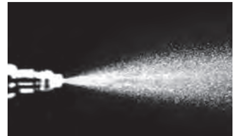
Patrón de pulverización del inyector tras Tratamiento P.i.
