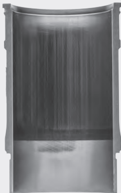
Revestimiento severamente rayado
